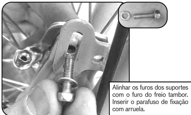
Alinhar os furos dos suportes com o furo do freio tambor. Inserir o parafuso de fixação com arruela.
