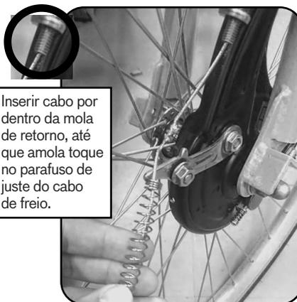
Inserir cabo por dentro da mola de retorno, até que amola toque no parafuso de juste do cabo de freio.
