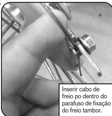
Inserir cabo de freio po dentro do parafuso de fixação do freio tambor.
