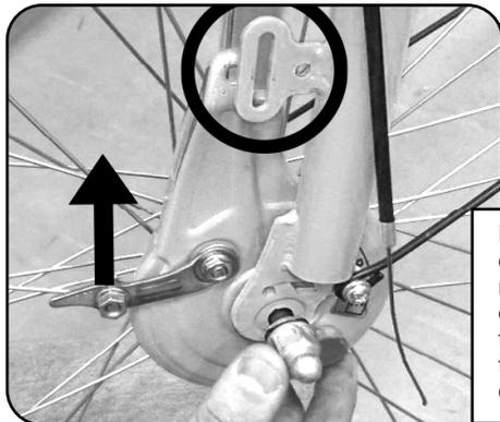
Inserir roda no quadro ou garfo, mantendo sempre o freio tambor por tras do suporte de fixação soldado no quadro/garfo.
