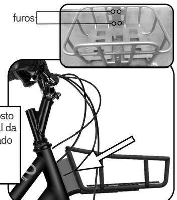
Posicione o cesto na parte frontal da bicicleta alinhado com os furos do cabeçote e parafuse
