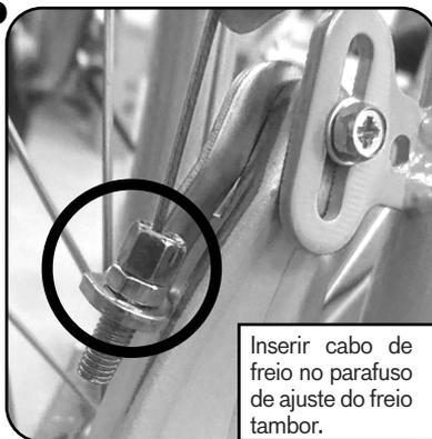
Inserir cabo de freio no parafuso de ajuste do freio tambor.
