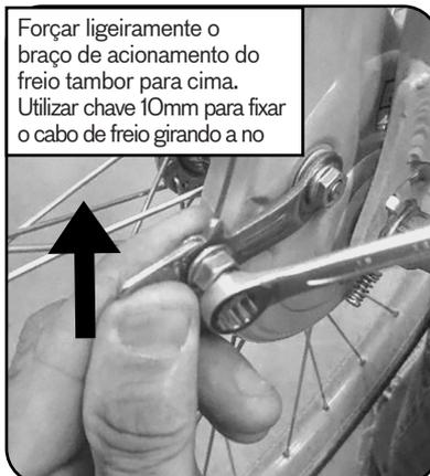
Forçar ligeiramente o braço de acionamento do freio tambor para cima. Utilizar chave 10mm para fixar o cabo de freio girando a no
