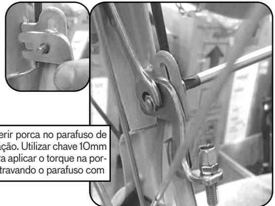
inserir porca no parafuso de fixação. Utilizar chave 10mm para aplicar o torque na porca travando o parafuso com
