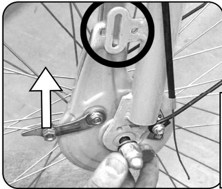
Inserir a roda no quadro ou garfo, mantendo sempre o freio tambor por trás do suporte de fixação soldado no quadro/garfo.
