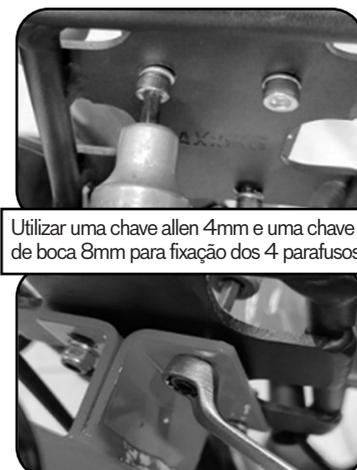
Utilizar uma chave allen 4mm e uma chave de boca 8mm para fixação dos 4 parafusos.
