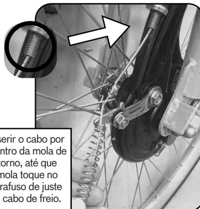
Inserir o cabo por dentro da mola de retorno, até que a mola toque no parafuso de ajuste do cabo de freio.
