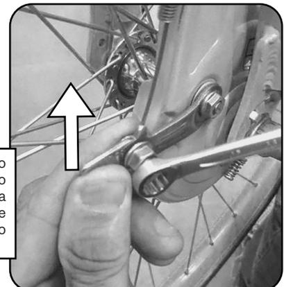
Forçar ligeiramente o braço de acionamento do freio tambor para cima. Utilizar chave de boca 10mm para fixar o cabo de freio.
