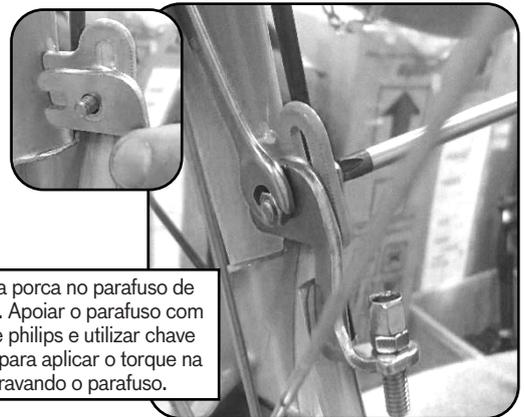
Inserir a porca no parafuso de fixação. Apoiar o parafuso com a chave philips e utilizar chave 10mm para aplicar o torque na porca travando o parafuso.
