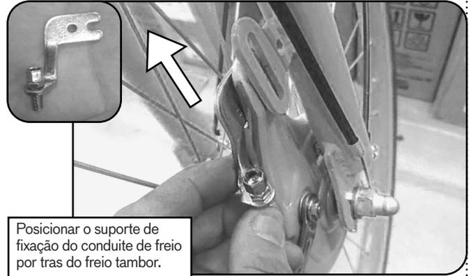
Posicionar o suporte de fixação do condute de freio por trás do freio tambor.
