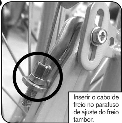
Inserir o cabo de freio no parafuso de ajuste do freio tambor.
