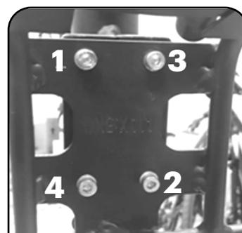
Fixar os parafusos conforme ordem indicada na figura acima. Formato em X.
