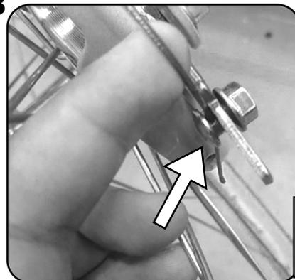
Inserir o cabo de freio por dentro do parafuso de fixação do freio tambor.
