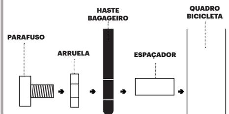
\*TORQUE DE APERTO PARA TODOS OS PARAFUSOS 4-5Nm
